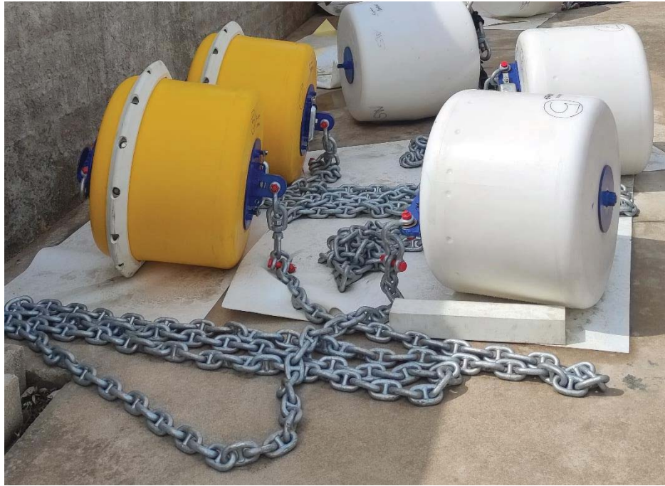
Figura 4.6.2.2: Boe di ormeggio con catenaria
