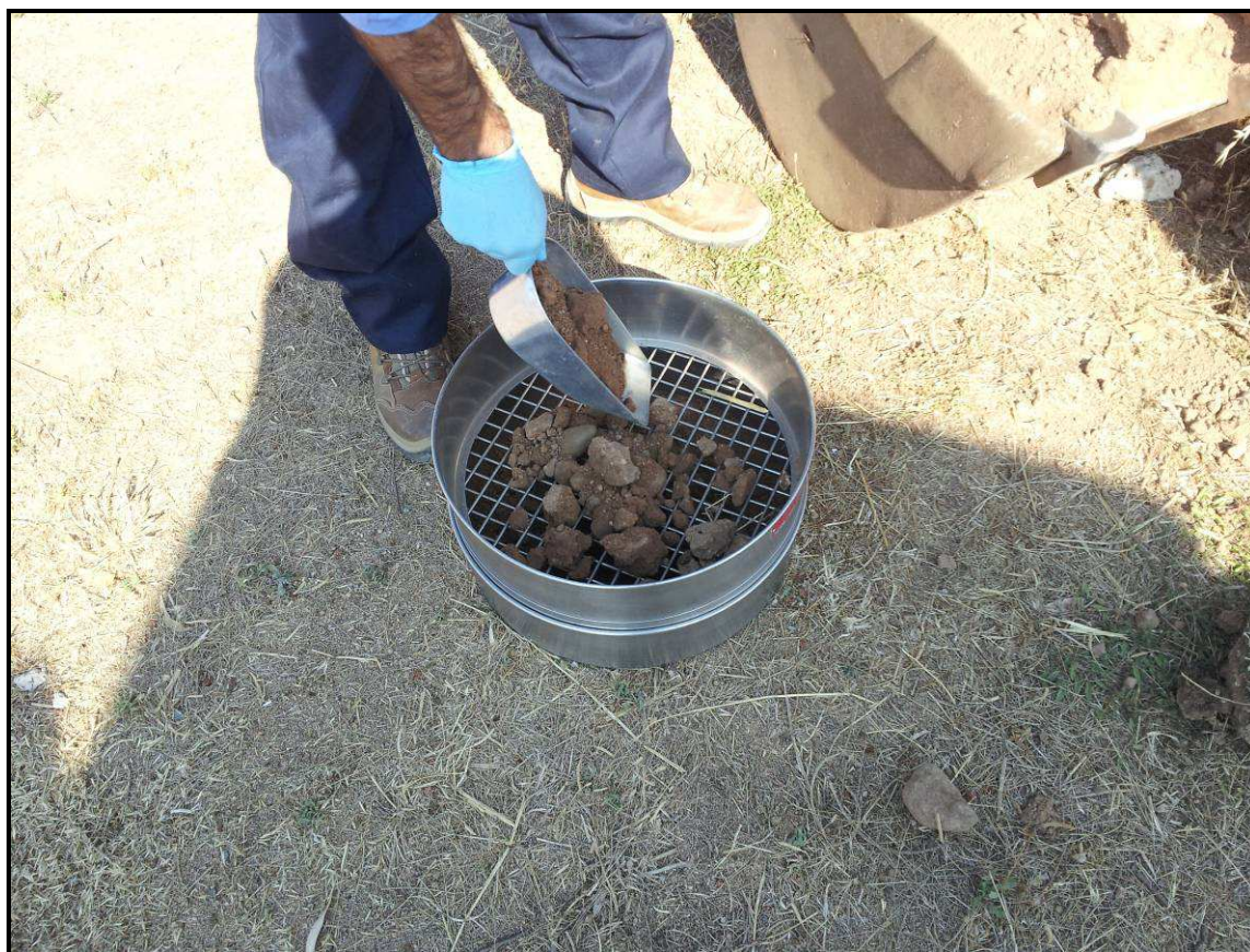
Figura 17 – Setacciatura del campione da analizzare.
