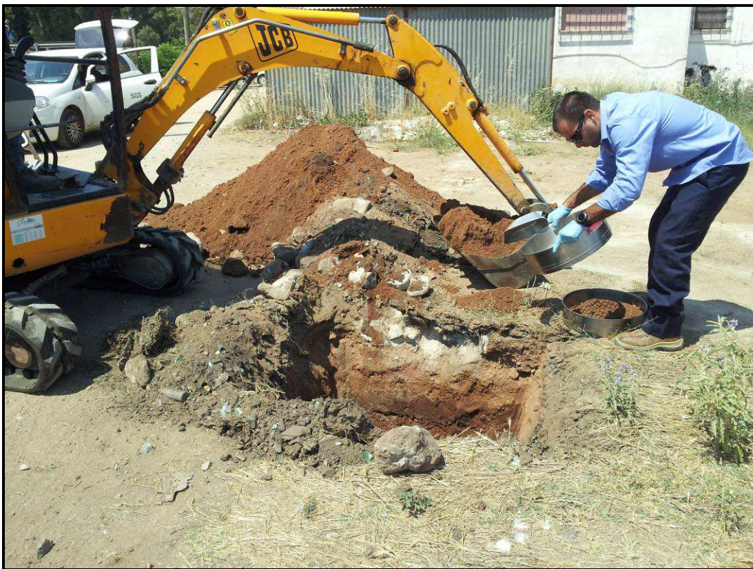
Figura 15 – Prelievo del campione.
