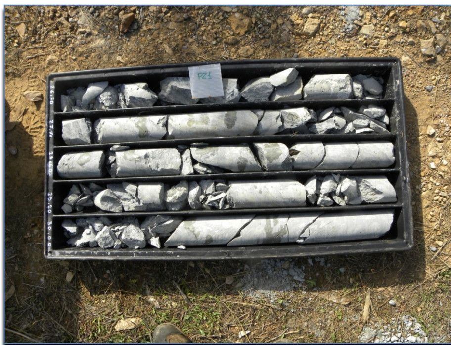
Foto 1 – Fratturazione delle rocce attraversate con sondaggio PZ1ND alla progressiva compresa tra 26,30 e 30,00 m da p.c.
