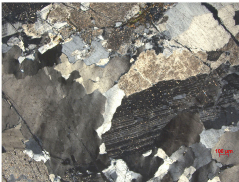
CMC2-1 (Foto 1) – Panoramica. Struttura tabulare. Presenza di fenocristalli quarzo e plagioclasio. Luce polarizzata, N+
