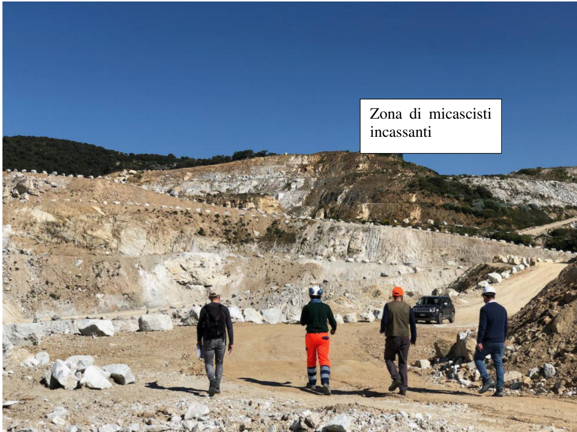
Foto 2: la parte alta della miniera dove sono evidenti le intercalazioni tettonizzate di micascisti incassanti delle plutoniti tardo erciniche
