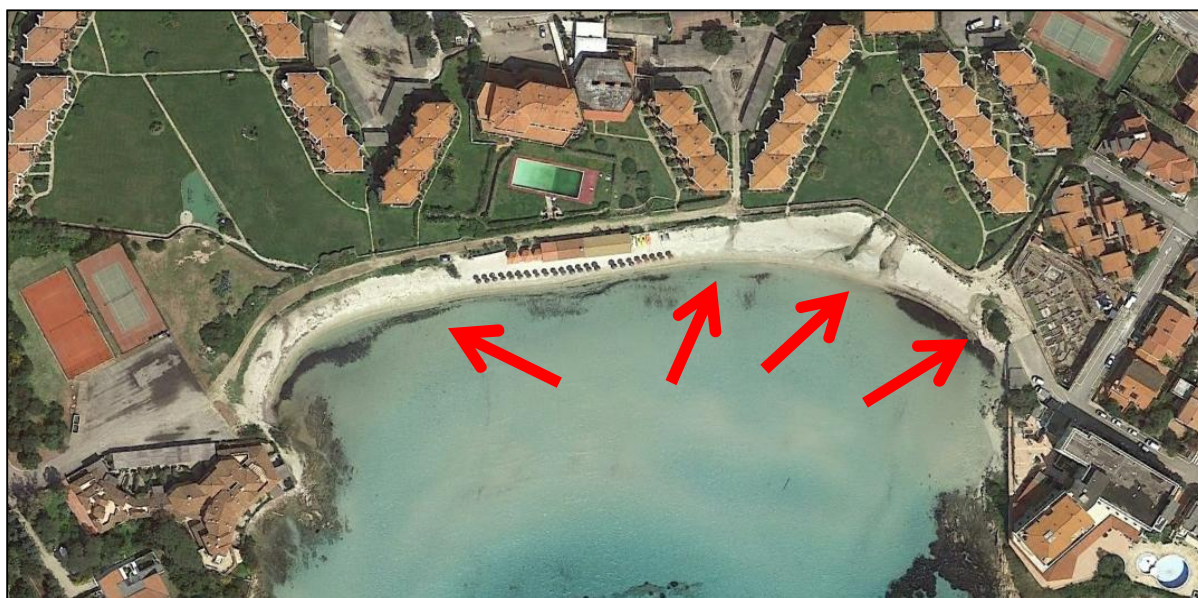
Fig.16 - Solchi di erosione (Gully erosion) sulla terza spiaggia (vista zenitale Aprile 2014)
