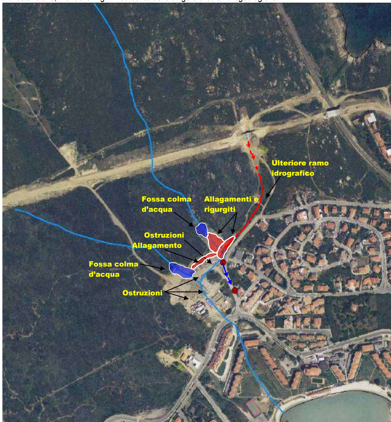
Fig.21- I principali elementi che ricostruiscono lo scenario attuale di un evento intenso di piena. La traccia idrografica in celeste è tuttavia quella teorica ricostruita su modello. In realtà a valle della SP. N.36 l'alveo è intercettato da una tubazione che sposta la foce all'estremità Ovest della falcata.
