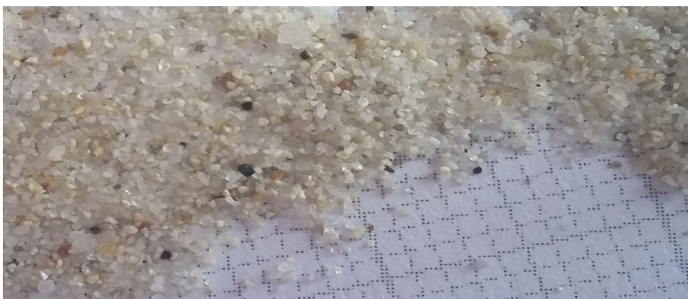
Fig. 3 - Ingrandimento della sabbia (Campione C1) su carta millimetrata (quadrati di 1 mm di lato)
