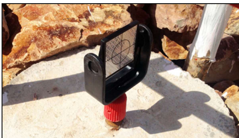
Figura 4.13/II: Esempio di mira topografica
