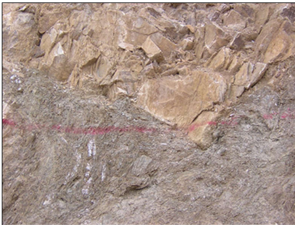
Figura 5.5/II: Particolare piega. Contatto calcari (in alto) e filladi in basso
