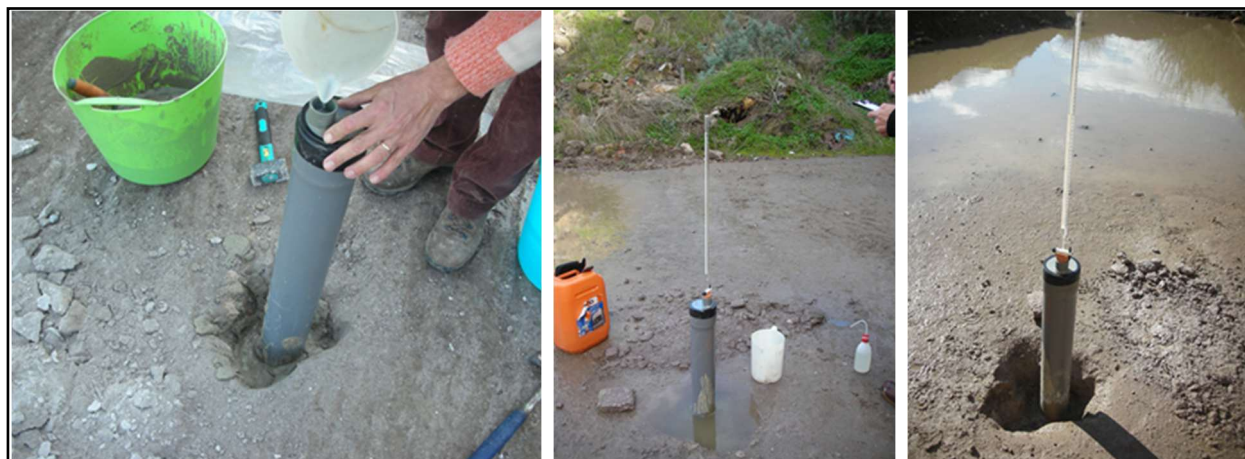
Figura 5.6/VIII: Prove di permeabilità
