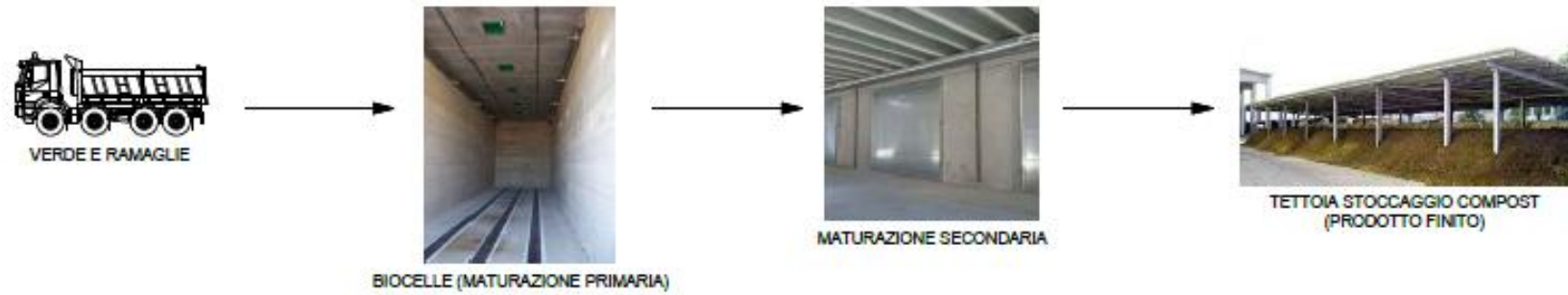
Figura 8. Schema Funzionale di processo_Linea compostaggio sottovaglio da impianto di preselezione
