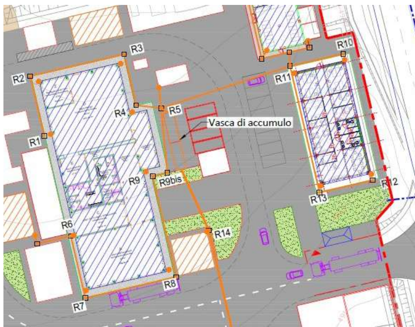
Figura 4: Particolare impianto di recupero acque dalle coperture.
