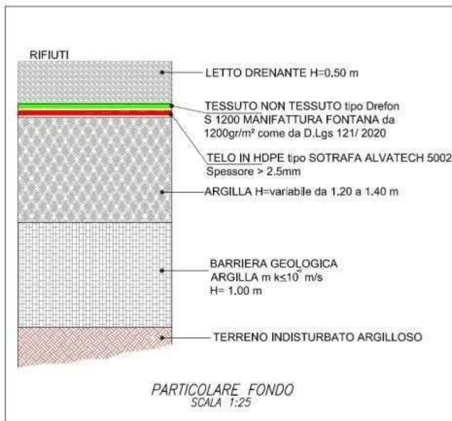
Figura 1- Particolare del pacchetto di impermeabilizzazione del fondo discarica- Estratto della Tavola 14
