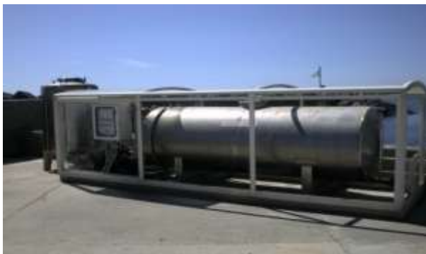
Ecostar aspirazione e raccolta acque di sentina e sewage
