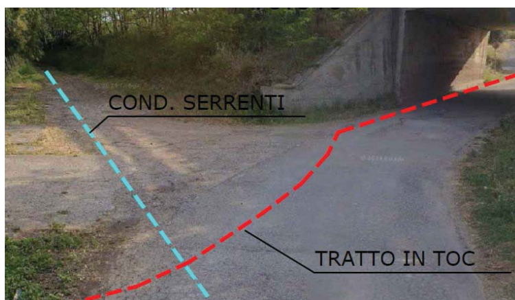
Figura 2: Interferenza Condotta Ripartitore Serrenti risolta con tratto in TOC
