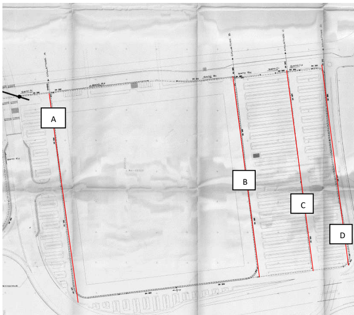
Figura 22 Rete di smaltimento acque meteoriche -. Stato attuale (fonte ufficio tecnico comunale)
