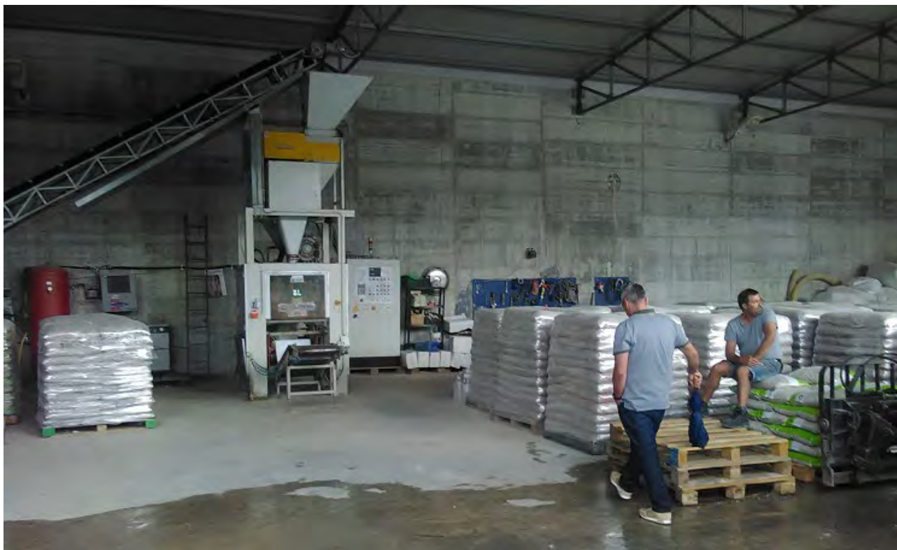
Impianto della Ditta F.Ili Cherchi – particolare del reparto insaccamento - (foto U. Angius)
