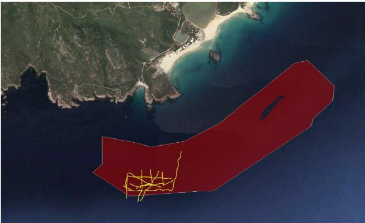
Figura 23: In rosso, l'area di acquisizione del Multibeam. In giallo, le rotte eseguite per la determinazione dei profili sismici con il subbottom profiler INNOMAR SES2000 COMPACT.
