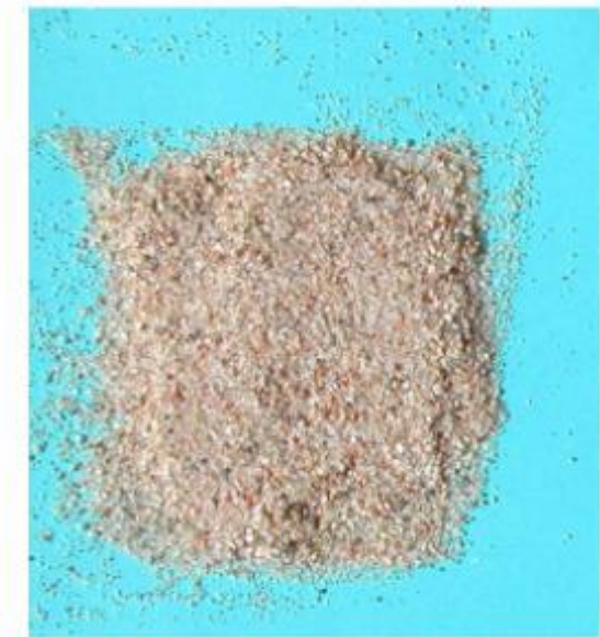
Foto 4. La sabbia di cava – dimensioni reali.
