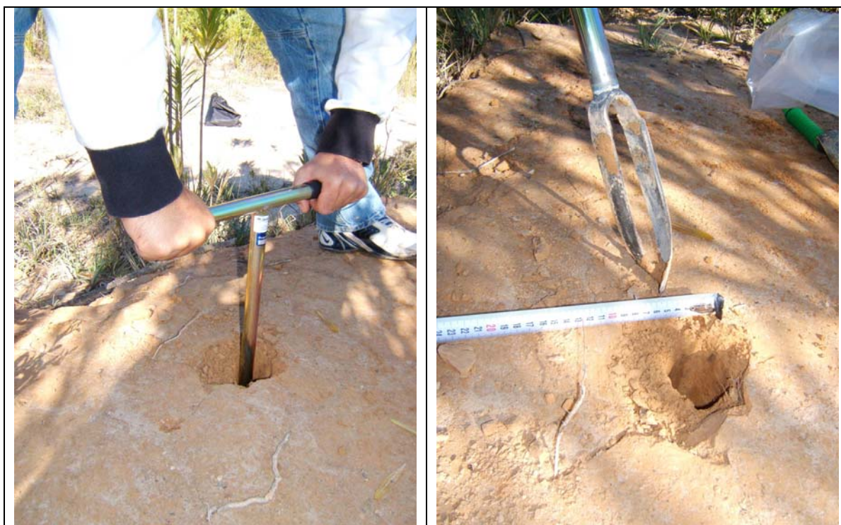
Figura 2.3. – Campionatura con carotatore manuale
