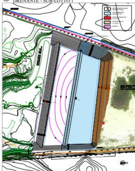
FASE 4 - TELO IMPERMEABILIZZANTE E STRATO DRENANTE - SUB-LOTTO I
