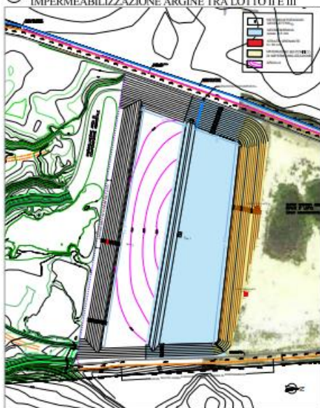
FASE 5 - MATERASSINO BENTONITICO DI IMPERMEABILIZZAZIONE ARGINE TRA LOTTO II E III
