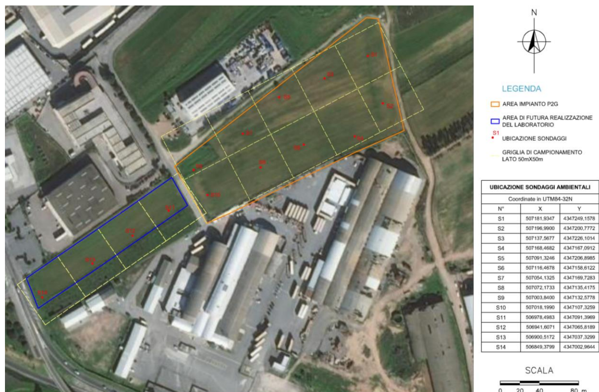
Figura 4.13: Planimetria con ubicazione dei sondaggi ambientali eseguiti ai fini della caratterizzazione dell'area impianti di Progetto
