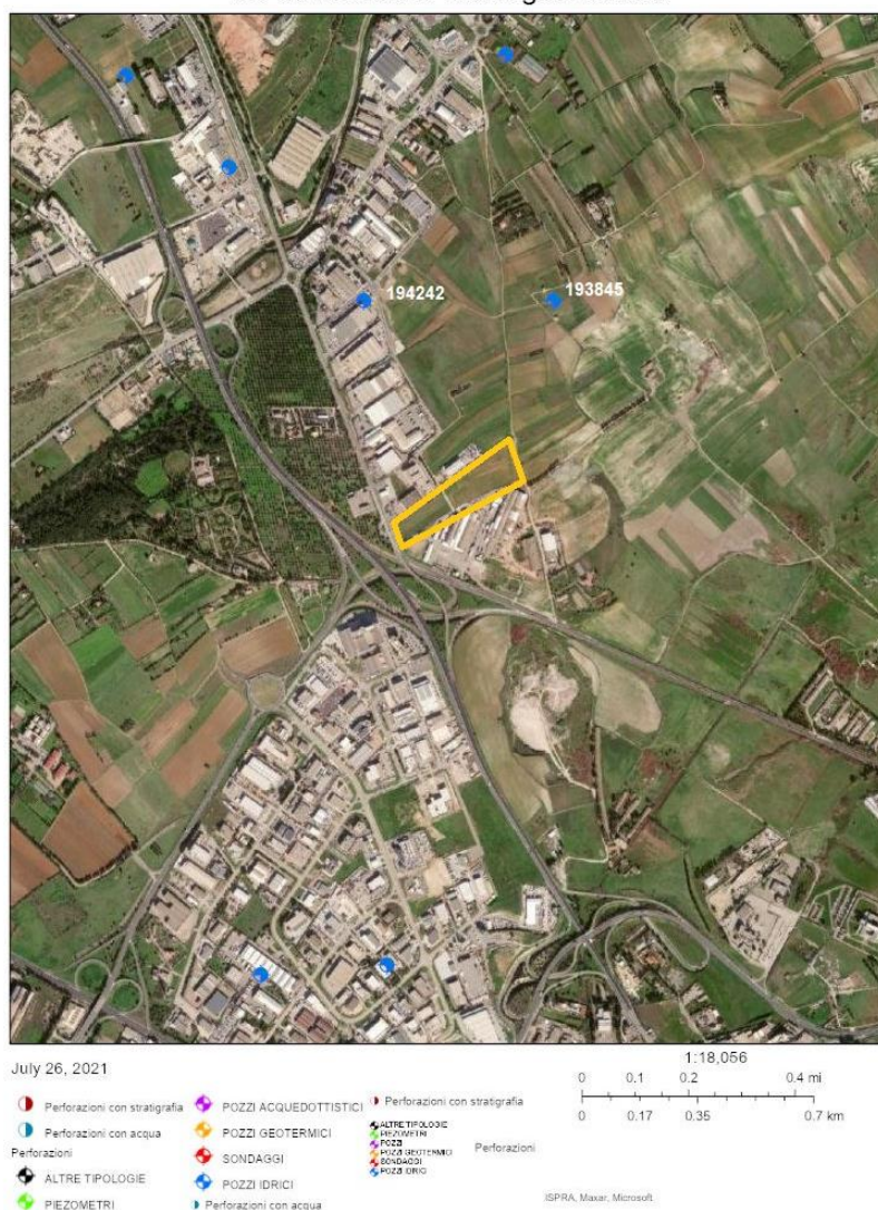
Figura 4.1: Localizzazione di pozzi per Acqua in prossimità del sito (Fonte Banca dati ISPRA "Archivio Indagini nel Sottosuolo")
