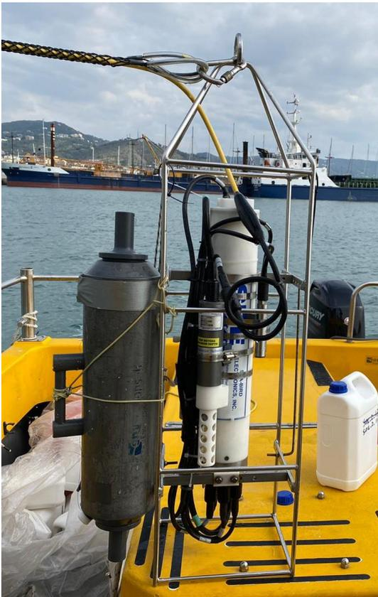
Fig. 4 - Sonda multiparametrica SBE 19 Plus V2
