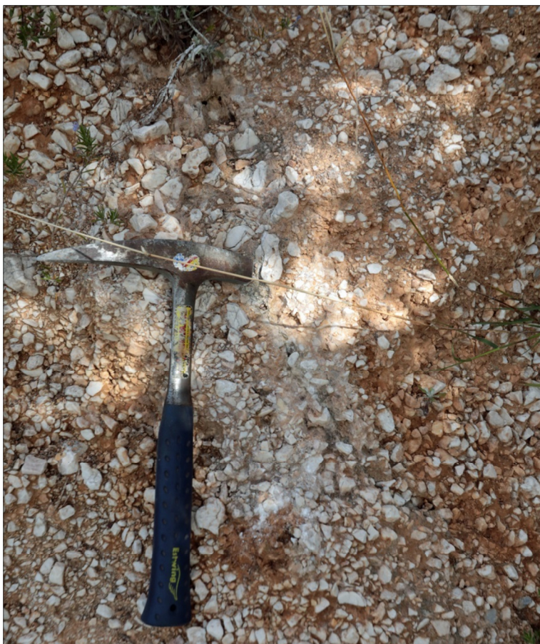
Fotografia 6. Particolare di un livello fortemente cementato, con consistenza litoide, interno alla sequenza detritica di versante tipo “ éboulis ordonnés ”. Sezione al limite Nord dell'impianto di depurazione.
