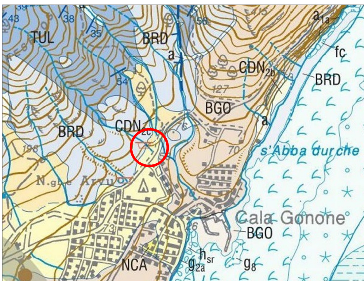
Figura 8. Stralcio fuori scala della Carta Geologica d'Italia in scala 1:50.000, Foglio 500. In rosso si evidenzia l'area di intervento, che ricade al limite tra dominio carbonatico (BRD) e le formazioni di copertura ascritte al Pleistocene
