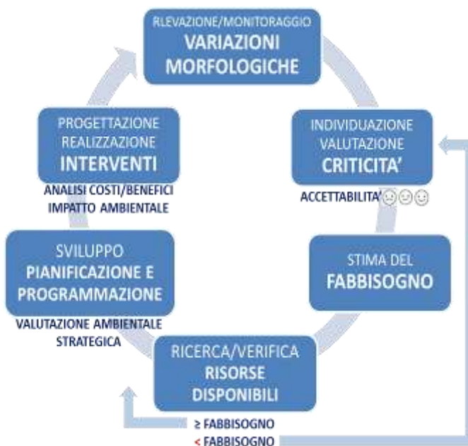
Figura II.1.1 – Proposta di schema per un corretto approccio alla valutazione e gestione dell'erosione costiera
