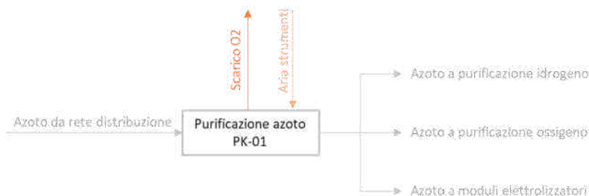
Figura 12 – Schema a blocchi del package di purificazione dell'azoto PK-01
