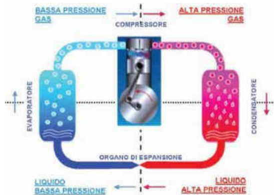
Figura 24: Schema del ciclo frigorifero
