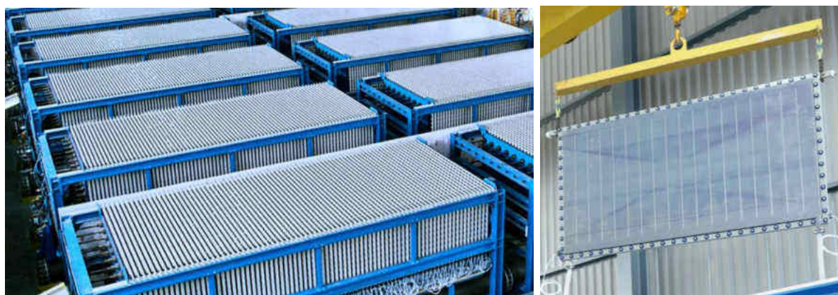
Figura 20 – Dettaglio delle celle elettrochimiche PEM
