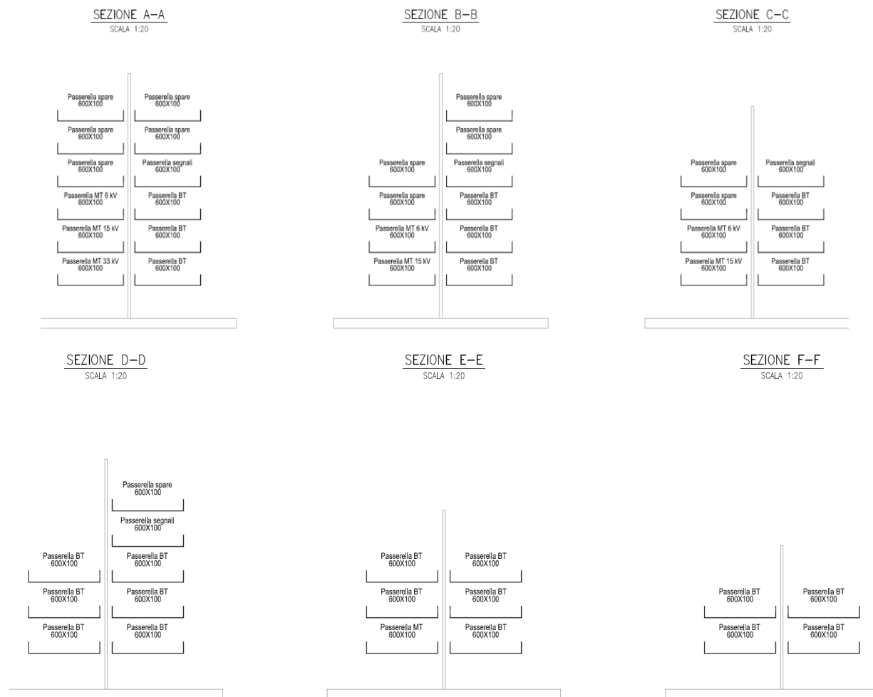
Figura 40 – Caratteristiche passerelle di sostegno delle linee in MT
