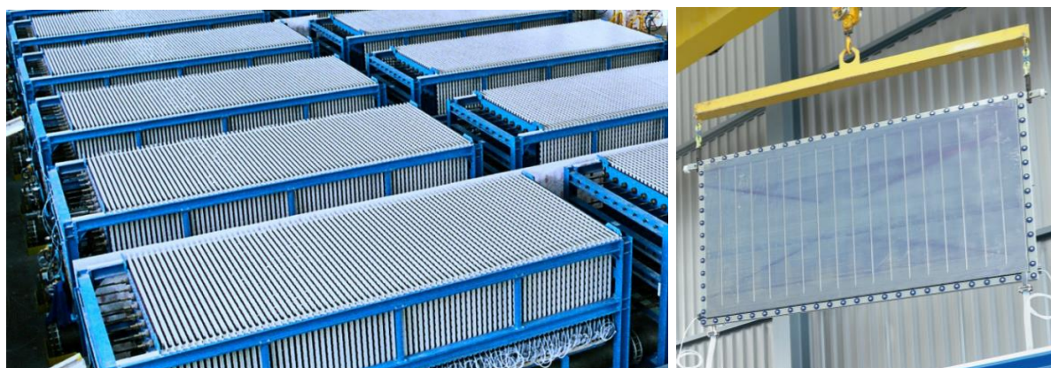
Figura 28 – Dettaglio delle celle elettrochimiche PEM
