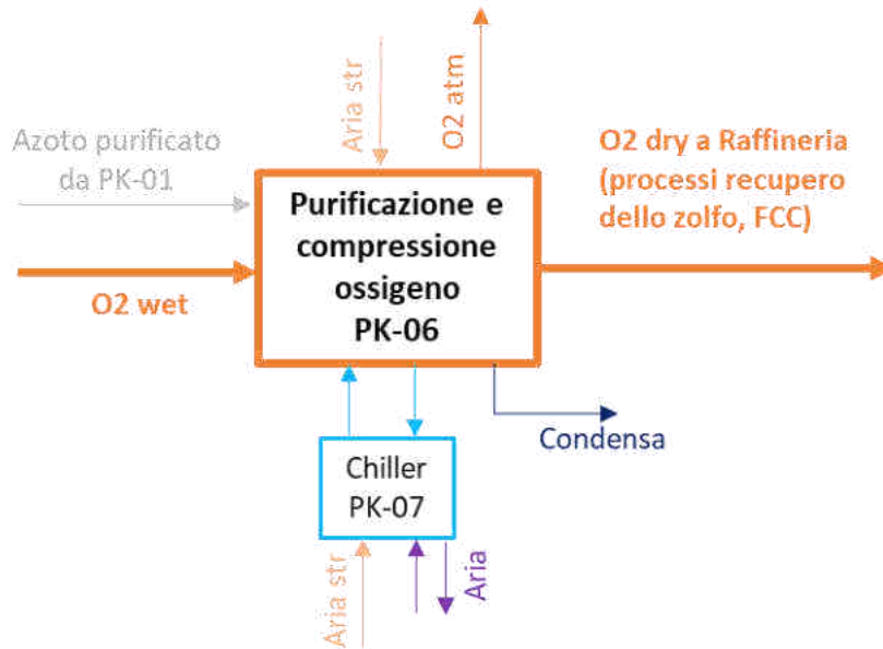
Figura 26 – Schema a blocchi del package di purificazione dell'ossigeno PK-06
