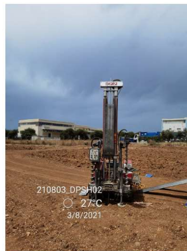
Figura 4.3: Esecuzione sondaggio P02 (A) e prova penetrometrica dinamica continua SCPT-1 (B)
