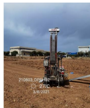
Figura 3.4: Esecuzione sondaggio P02 (sinistra) e prova penetrometrica dinamica continua SCPT-1 (destra)
