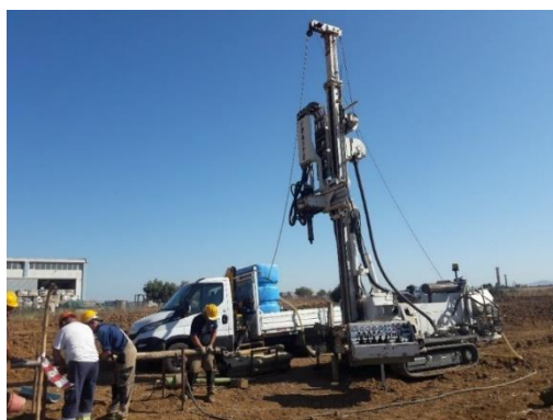
Figura 3.4: Esecuzione sondaggio P02 (sinistra) e prova penetrometrica dinamica continua SCPT-1 (destra)
