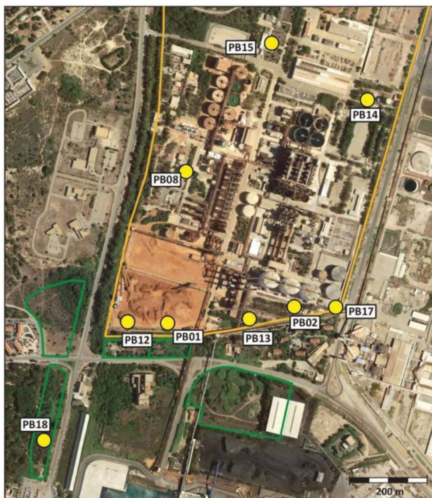
Figura 35. Pozzi barriera idraulica MISO stabilimento (SARTEC 2008)
