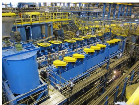
Fig. 15: Vista di un moderno impianto di flottazione multilivello e batteria di filtropresse per la disidratazione dei fanghi
