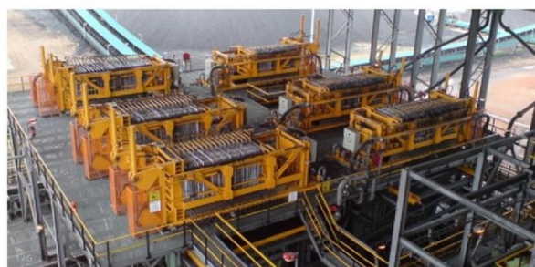
Fig. 15: Vista di un moderno impianto di flottazione multilivello e batteria di filtropresse per la disidratazione dei fanghi
