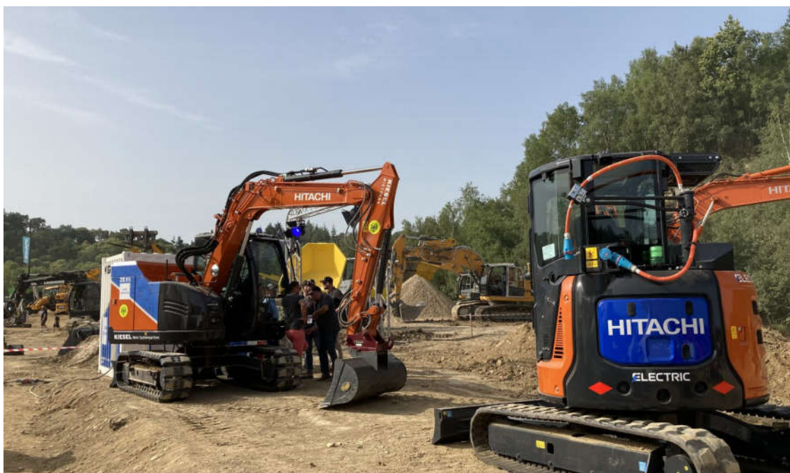
Figura 4-2_ Scavatori di ridotte dimensioni e peso con cingoli gommati
