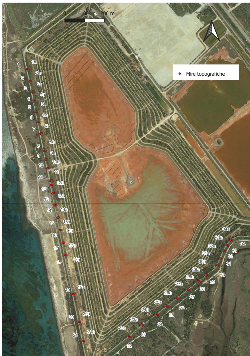
Figura 2. Indicazione delle mire topografiche nel monitoraggio integrativo dell'argine principale
