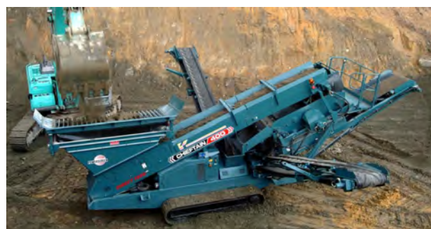
Figura 37 - macchina vagliatrice Powerscreen Chieftain 400 Track
