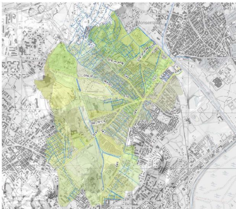
Figura 3.7 – Bacini idrografici e schema planimetrico dei collettori pluviali principali a servizio della rete fognaria di Pirri.
