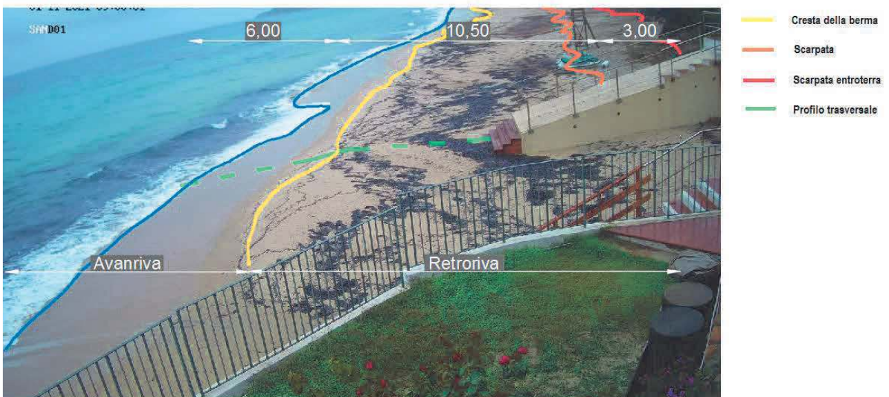
Figura 9: Individuazione delle diverse componenti del profilo trasversale di spiaggia;
