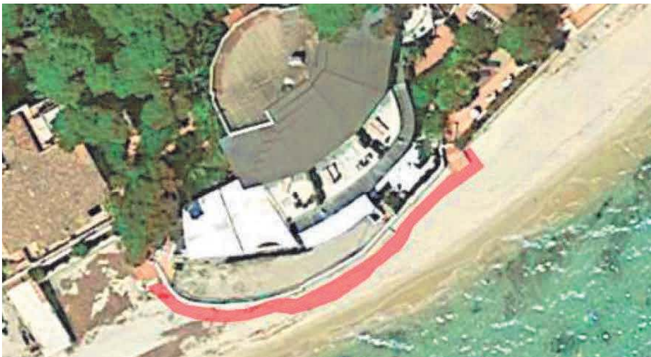
Figura 21: Planimetria delle opere di protezione radenti alla base della struttura;
