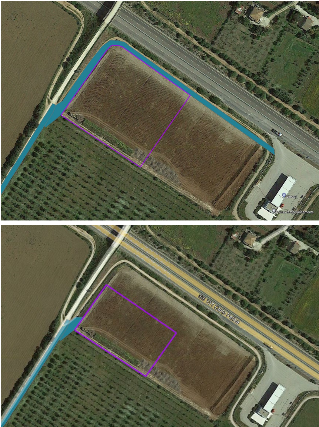
Figura 4: confronto tra l'ingombro originario dell'area di cantiere (in alto) e quello derivante dalla modifica progettuale. Come evidente, è stato stralciato l'accesso all'area di cantiere dalla S.S. 131.
