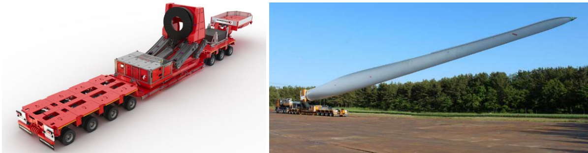
Figura 2: immagini relative al mezzo di trasporto speciale delle pale degli aerogeneratori, detto “blade-lifter”.
