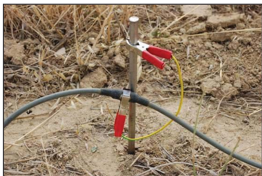
Foto 3: Connessione tra cavi multipolari ed elettrodi
