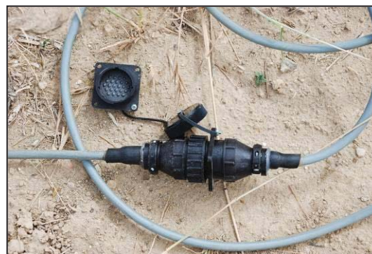
Foto 4: Connessione tra le sezioni di cavi multipolari
