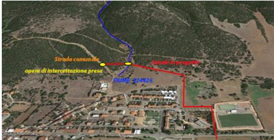
Figura 14: Inquadramento “sintetico” dell’opera a monte. In giallo la collocazione delle opere di “presa” intercettazione dei deflussi che oggi percorrono la piccola strada comunale e quella che scorre nell’elemento idrico denominato FIUME_324426
