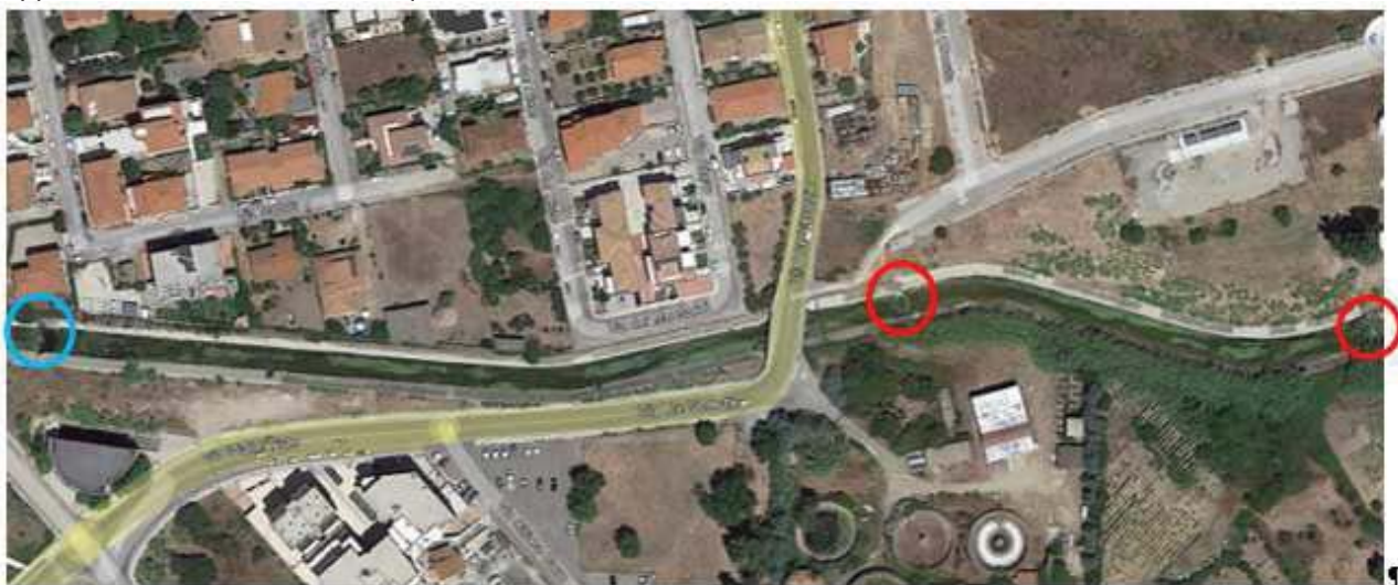
Fig 1. Indicazione dei due salti di cui si è considerata la rimozione (nei cerchi rossi): procedendo da monte verso valle, il primo è il limite di intervento della configurazione n.2, il secondo quello della configurazione n.3. Nel cerchio blu, il salto di monte fino al quale si è considerato di estendere la riprofilatura dell'alveo artificiale
