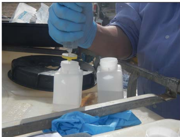
FOTO 1 - Procedura di filtrazione della matrici liquida.
