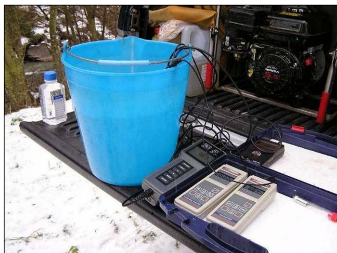
Foto 7 – Set di strumenti per misurazione dei parametri chimico-fisici di campo
