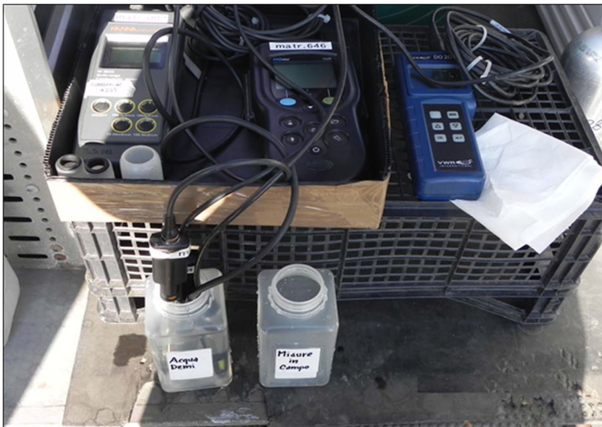
FOTO 1 - Esempio di misurazione con sonda multiparametrica.
