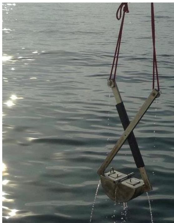
Figura 4. La benna di Van Veen utilizzata in opera.
