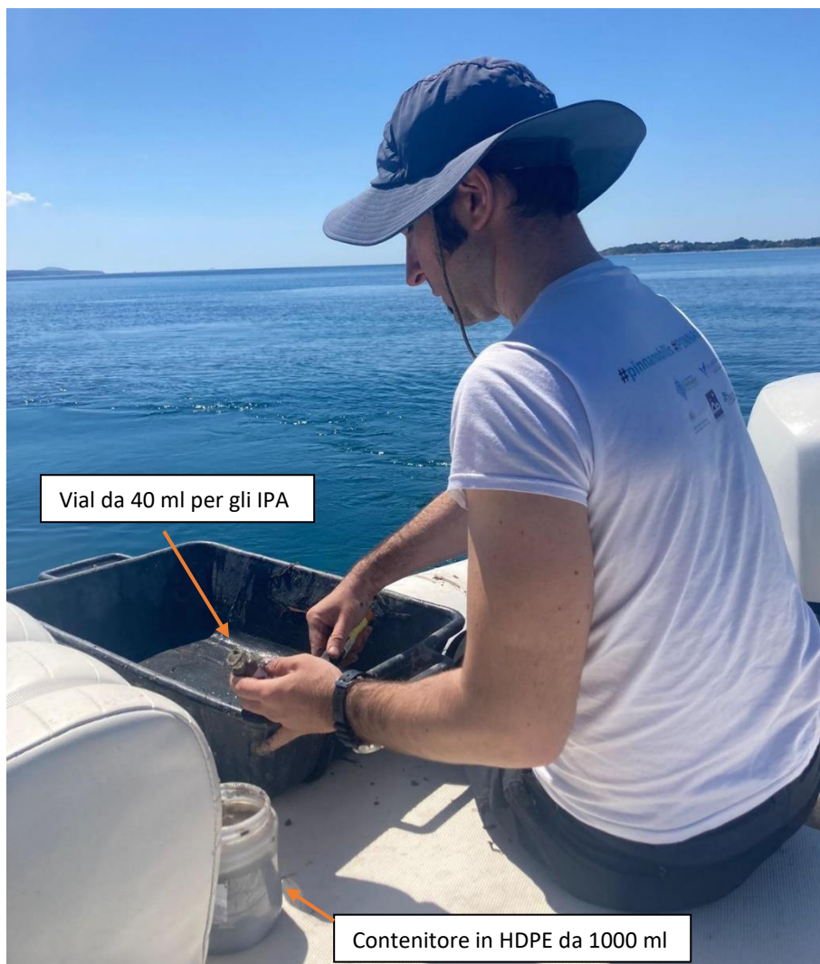
Figura 5. Il campionamento del sedimento.
