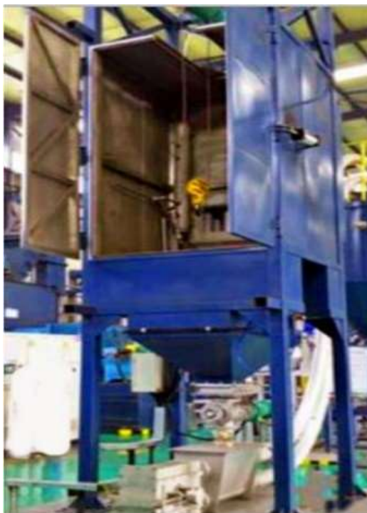
Figura 26 Esempio di sistema integrato di apertura sacconi e trasporto
