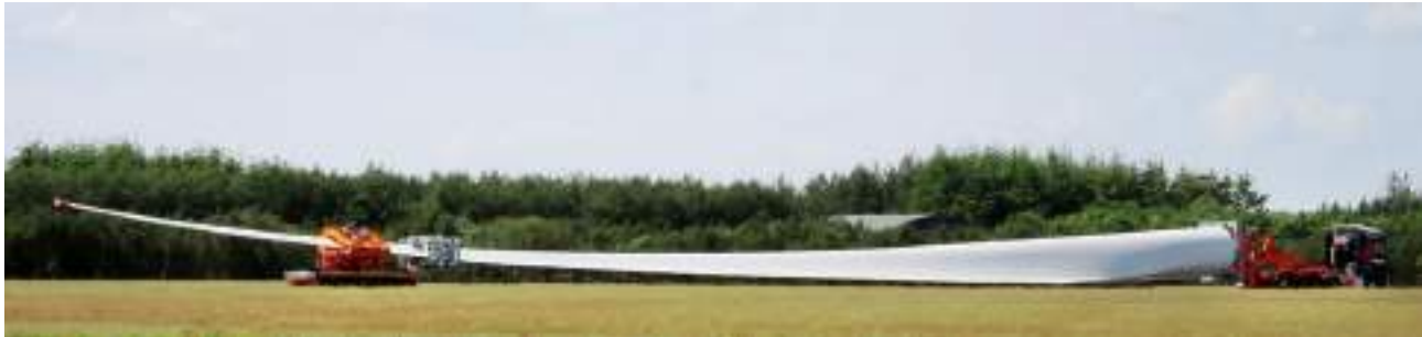
Figura 128 – Esempio di trasporto con "RBTS" (Rotor Blade Transport System)
