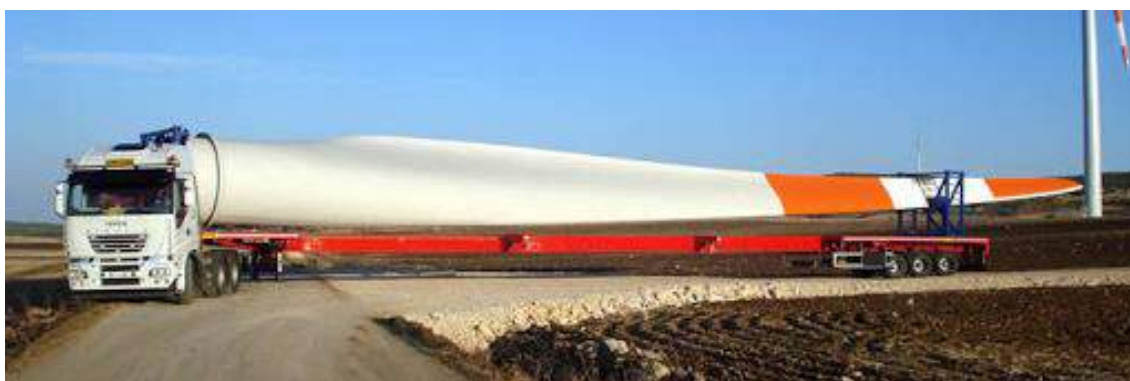
Figura 141 - Soluzione tipo del trasporto delle pale e pista di nuova realizzazione tipo per l'accesso alla turbina
