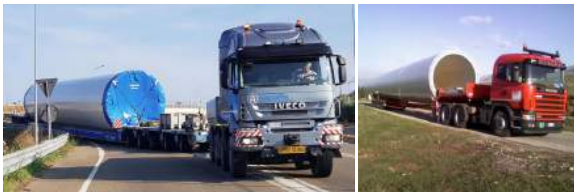
Figura 129 – Esempio di trasporto con convogli a pianale allungabile per conchi di torre
