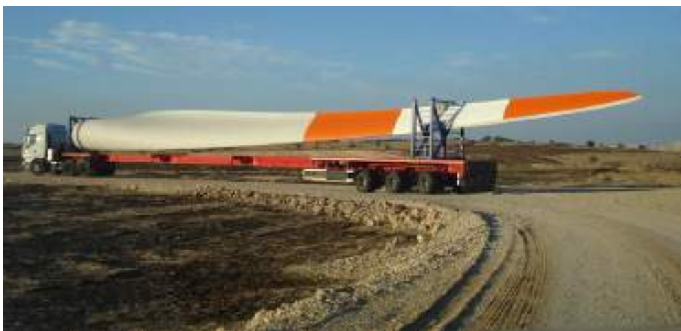
Figura 140 - Soluzione tipo del trasporto delle pale e adeguamento in curva tipo sulla viabilità esistente
