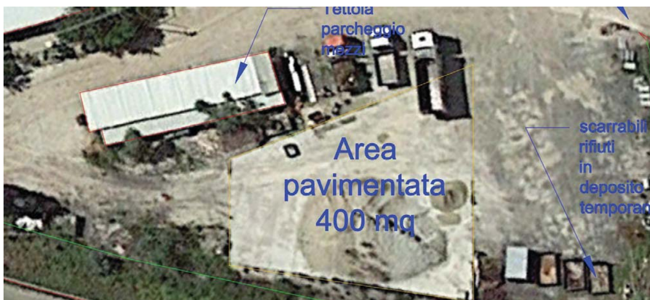
Figura 13 - Piattaforma di calcestruzzo realizzata nel 2019 da utilizzare come messa in riserva R13 CER 170302
