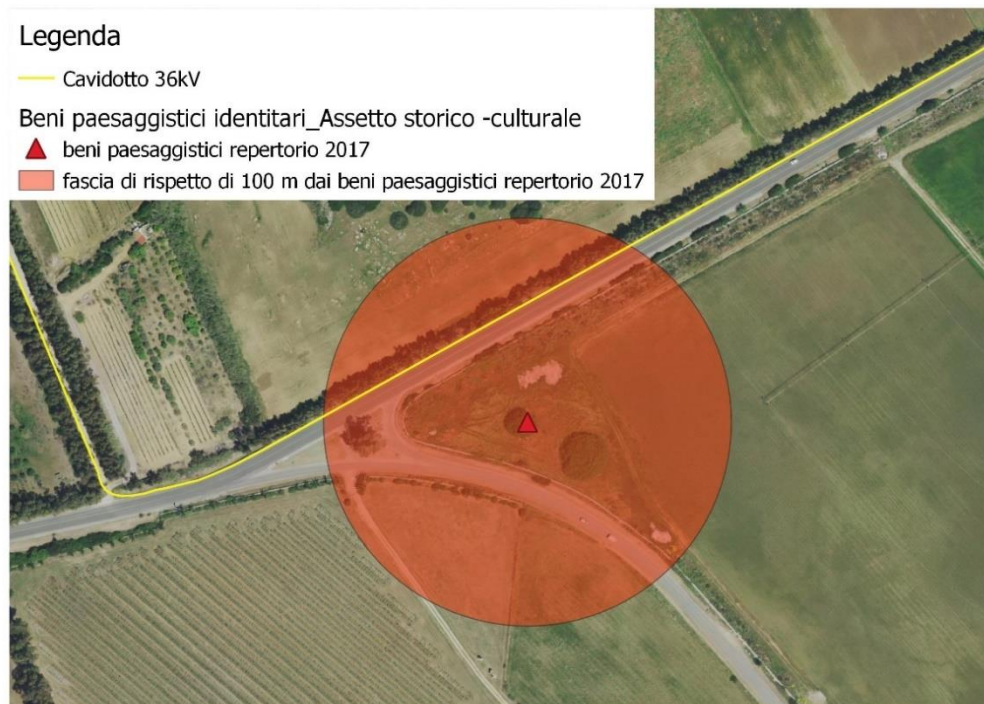
Figura 5.6: Sovrapposizione del cavidotto a 36kV con buffer di tutela paesaggistica di 100m da beni e manufatti di valenza storico culturale "Nuraghe Bonassai"
