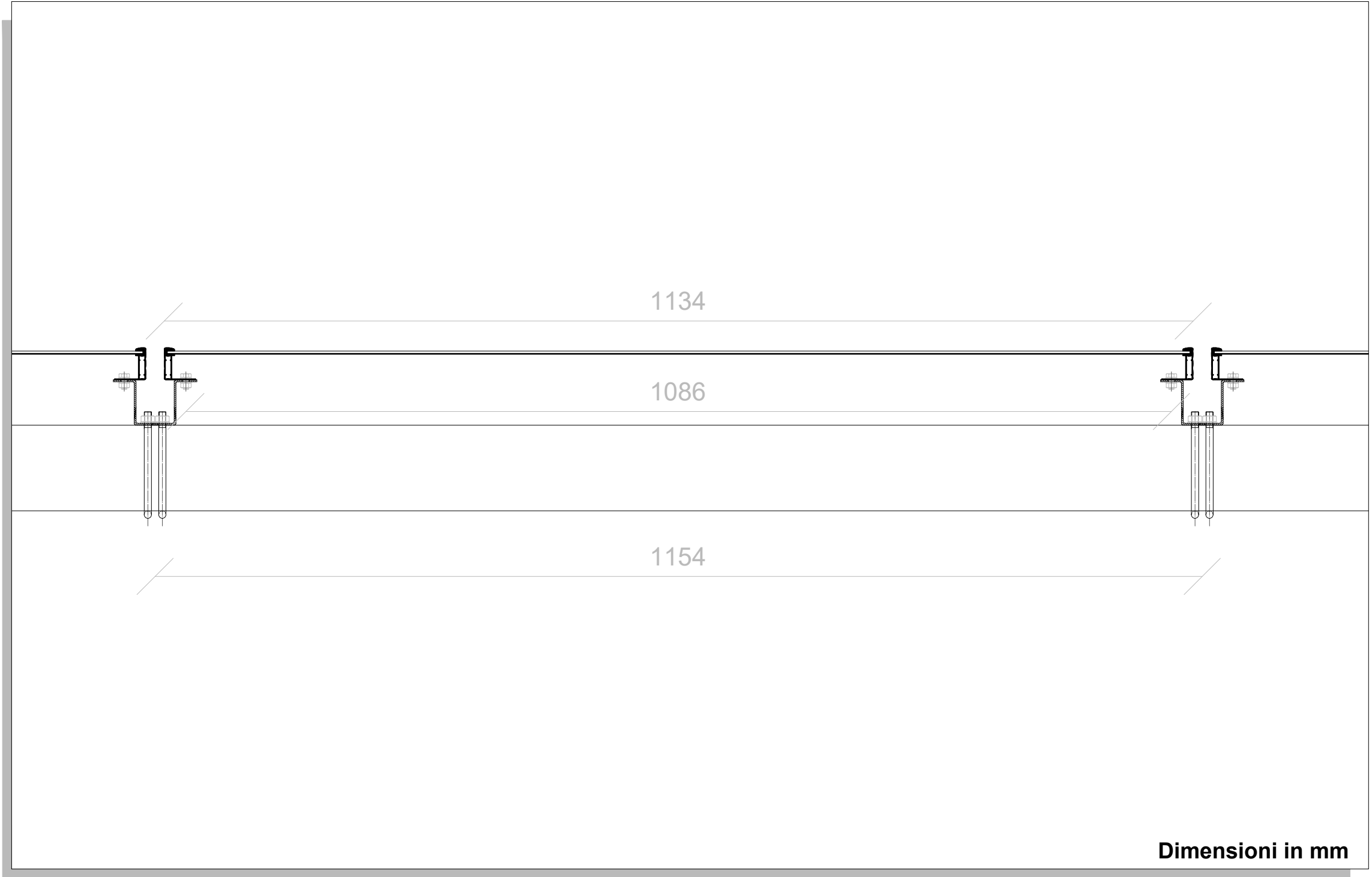
PARTICOLARE ATTACCO DEL PANNELLO SCALA 1:5
