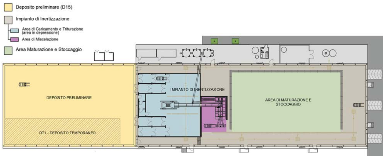
Figura 2 - Planimetria del Deposito Preliminare e dell'Impianto di Inertizzazione.
