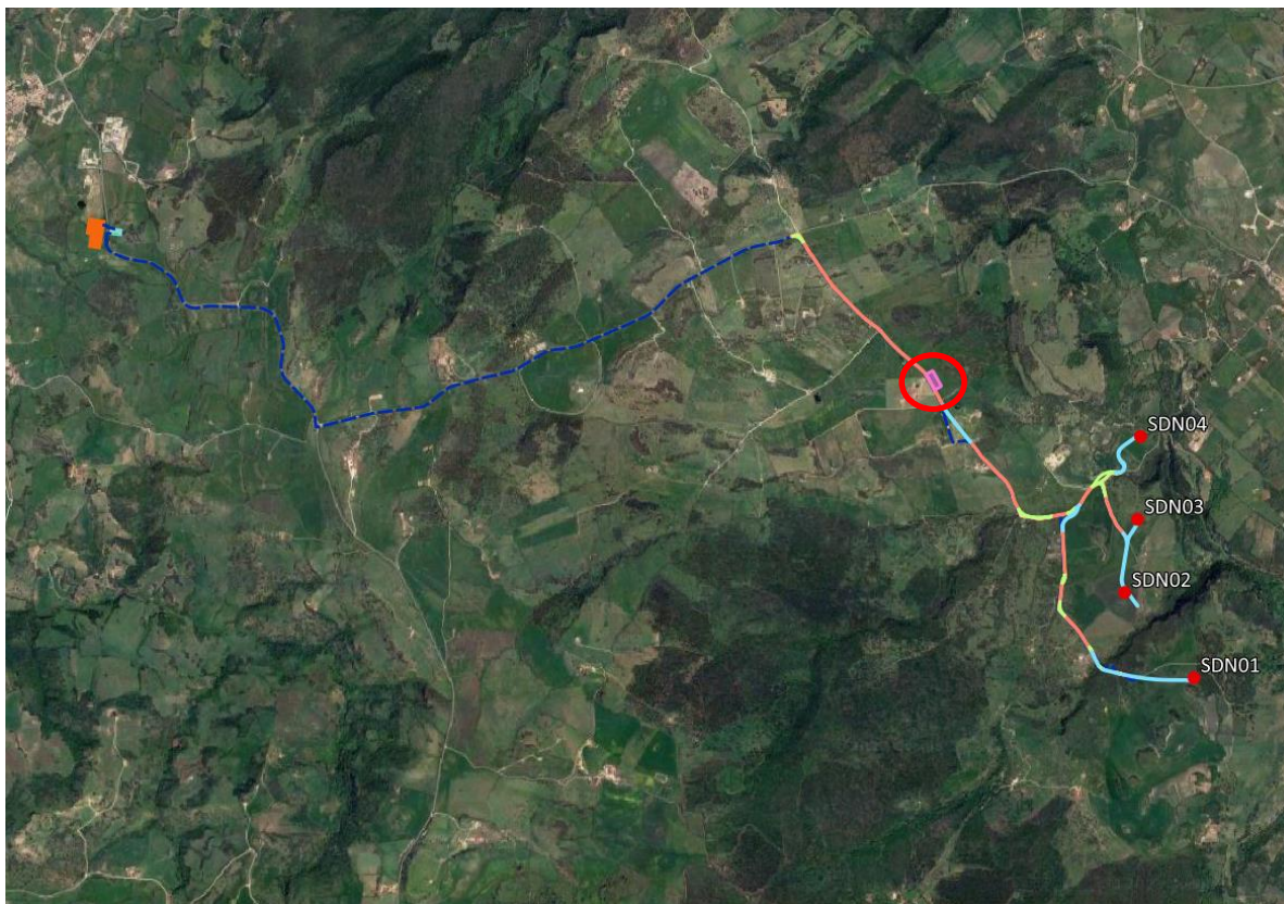
Figura 4.37: Localizzazione dell'area di deposito temporaneo prevista per la fase di cantiere, la freccia indica il possibile ingresso dei mezzi di cantiere. Sotto: ubicazione dell'area di deposito temporaneo rispetto al layout di progetto (cerchio rosso).
