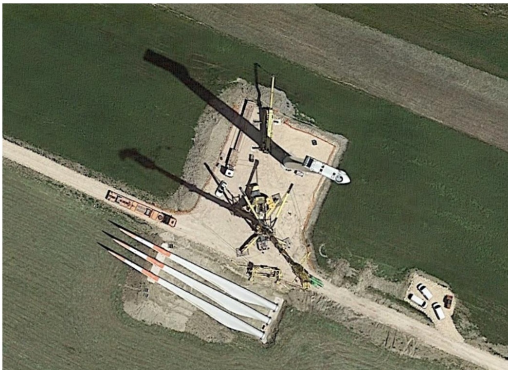
Figura 4.12 – esempio di piazzola in fase di costruzione
