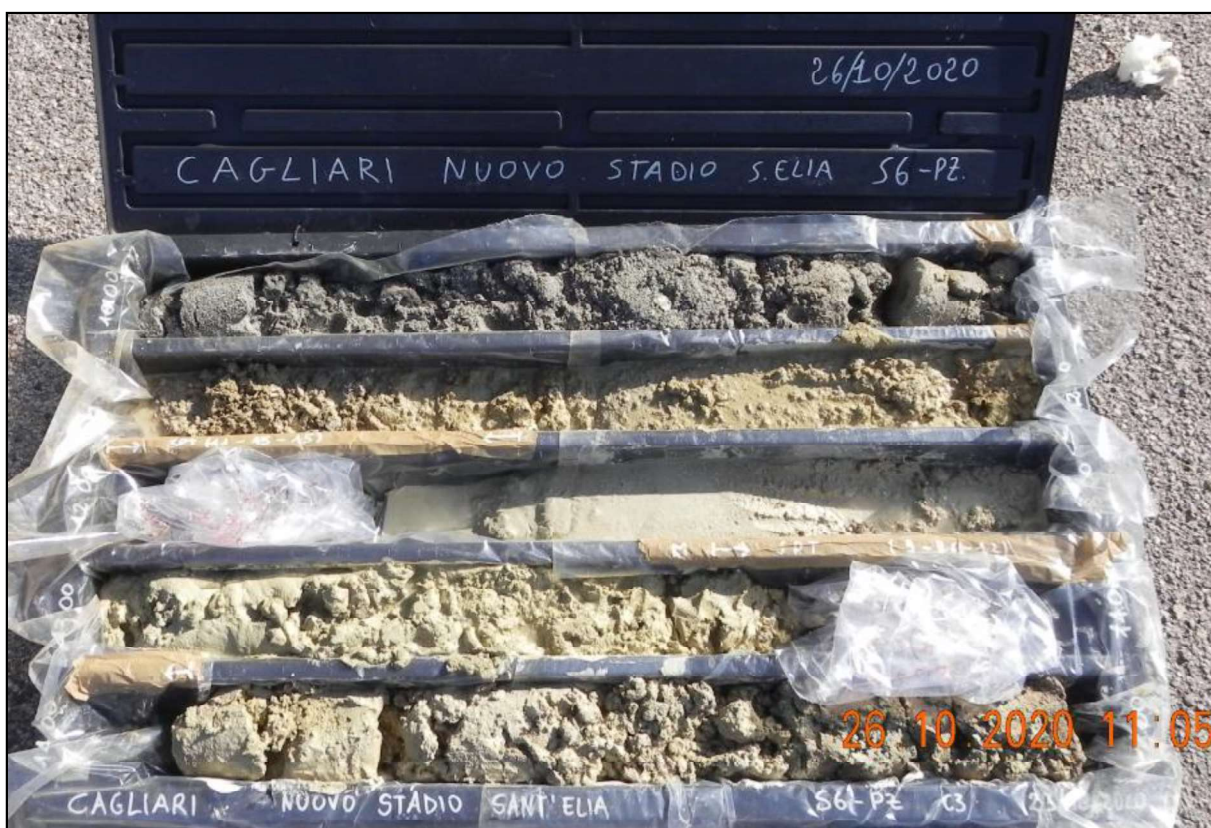
FOTO 3.4 – Cassetta catalogatrice del sondaggio S6_PZ ove è stato riscontrato lo spessore massimo dello Strato B3. Nello specifico le carote riguardano l'intervallo di profondità 10,00÷15,00 m . Gli aspetti più distintivi rispetto agli strati B1 e B2 riguardano l'assenza di fibra di Posidonia oceanica e la presenza di livelli semincementati da carbonato di calcio.
