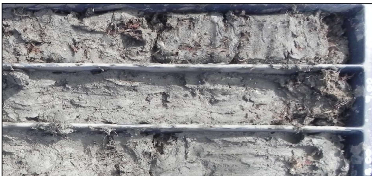
FOTO 3.3 – Aspetto dei depositi sabbioso-limosi ricchi in "paglia marina" in decomposizione estratti da S2.
