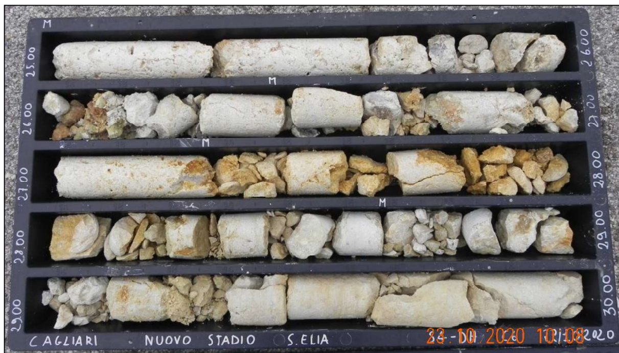
FOTO 3.8 – Carote del sondaggio S4_DH nell'intervallo di profondità 25,00÷30,00 m, che mostrano la litofacies “Tramezzario” con i giunti ossidati variamente orientati. L'ultimo metro (da –29,00 m) rappresenta un calcare marnoso molto simile alla litofacies “Pietra Cantone”.
