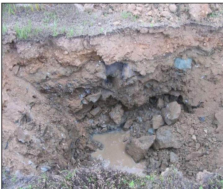
FOTO 3.9 e 3.10 – Flusso idrico proveniente dalla coltre di riporto imbibita (indagini presso Arena Spettacoli).
