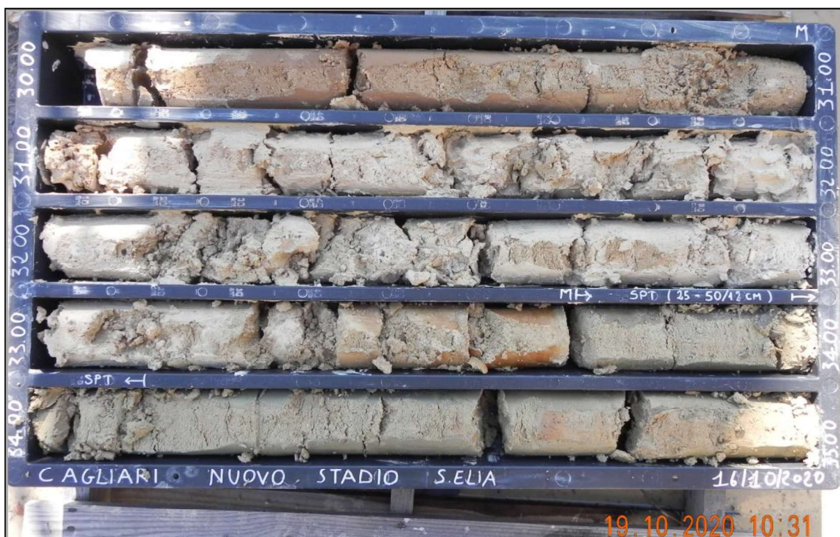
FOTO 3.6 – Casseta catalogatrice del sondaggio S3_DH che mostra la parte terminale della perforazione (intervallo 30,00÷35,00 m) essenzialmente entro lo Strato D. La litofacies D2, costituita dalla breccia calcarea, è stata rinvenuta tra -27,7÷-29,50 m e -31,00÷33,30 m.
