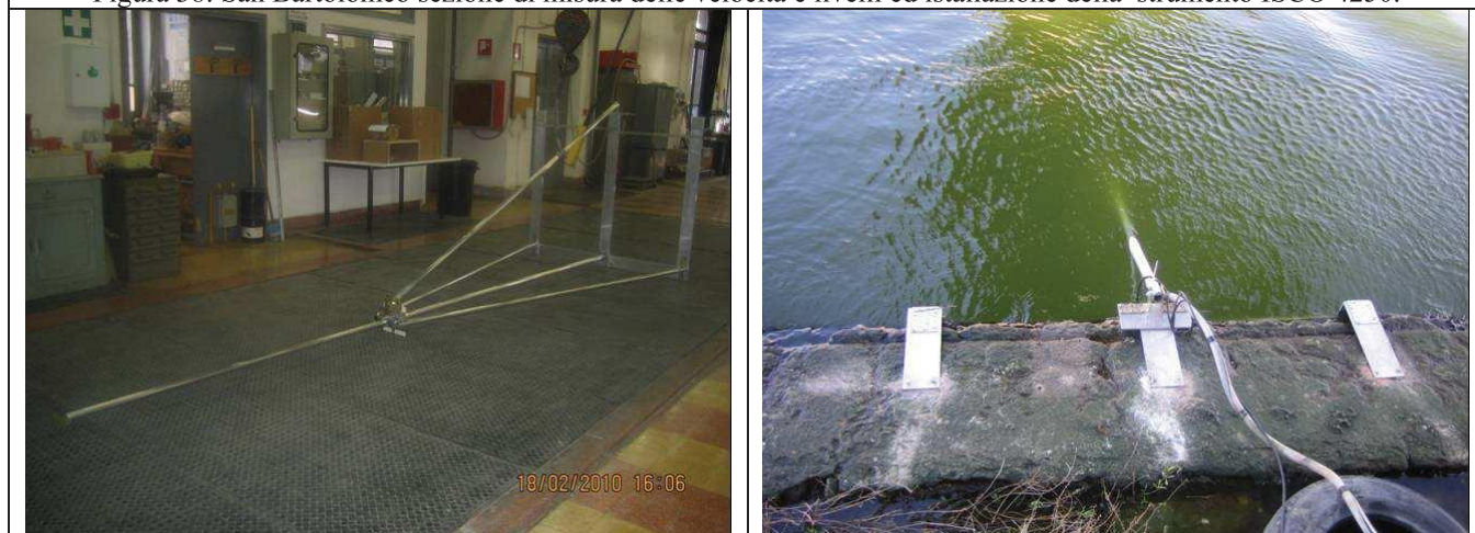
Figura 39: Braccio che sostiene la sonda ISCO 4250 dal 24 febbraio 2010 al laboratorio G. Fantoli del Politecnico di Milano e particolare dell'installazione dello stesso alla sezione 11 del canale San Bartolomeo
