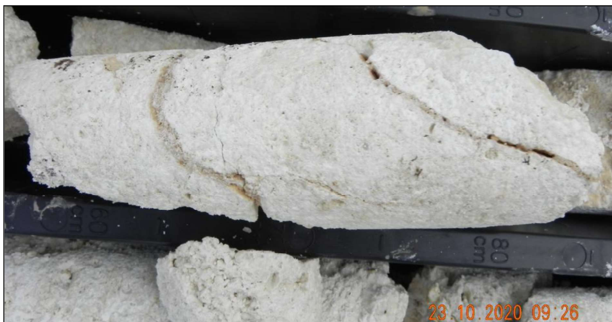
FOTO 3.7 – Spezzone di roccia “Tramezzario” con giunti obliqui estratto dal sondaggio S4_DH.
