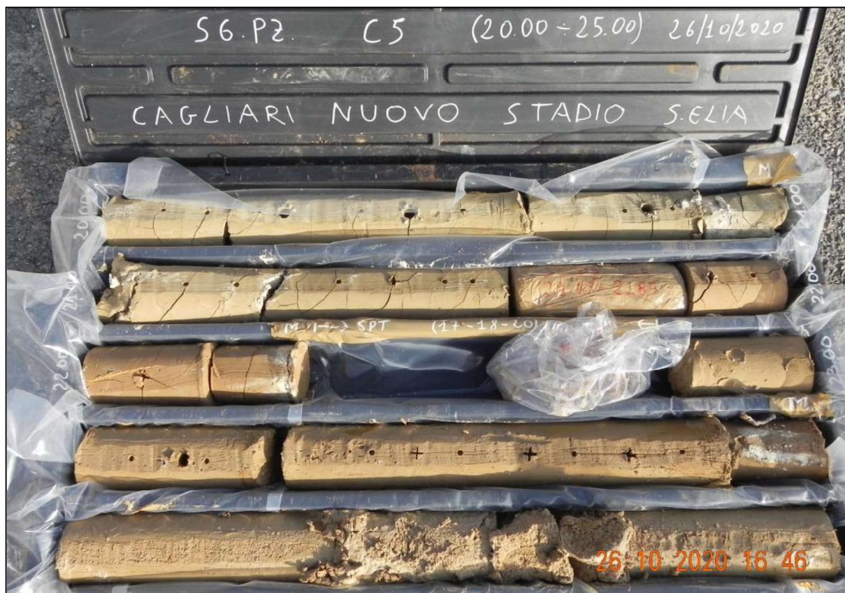
FOTO 3.5 – Casseta n. 5 del sondaggio S6_PZ che mostra il passaggio, a partire da quota -24,40 da p.c., tra la facies prevalentemente argillosa dello Strato C con quella contenente una progressiva componente sabbiosa.
