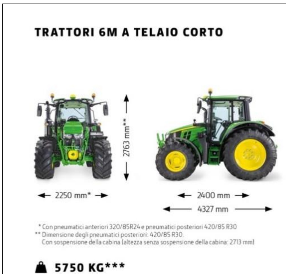
Figura 14 - Specifiche tecniche del trattore 6M a telaio corto
