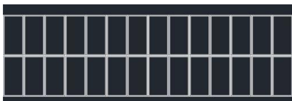
Tracker con sistema fotovoltaico – Tipo 2X28 moduli e 2X14 moduli
