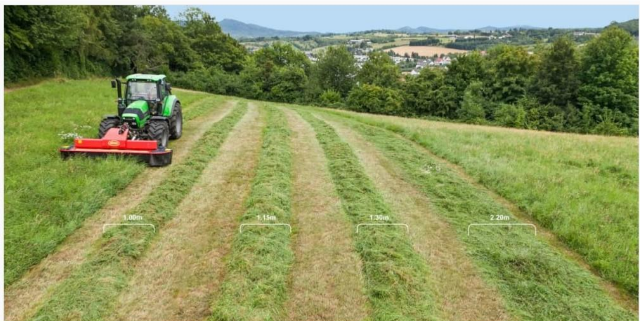
Figura 16 - Immagine della falciatrice anteriore e larghezze delle andane realizzabili
