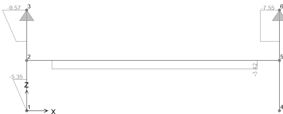
Figura 6.13. Trasverso di campata – Sforzo di taglio SLU
