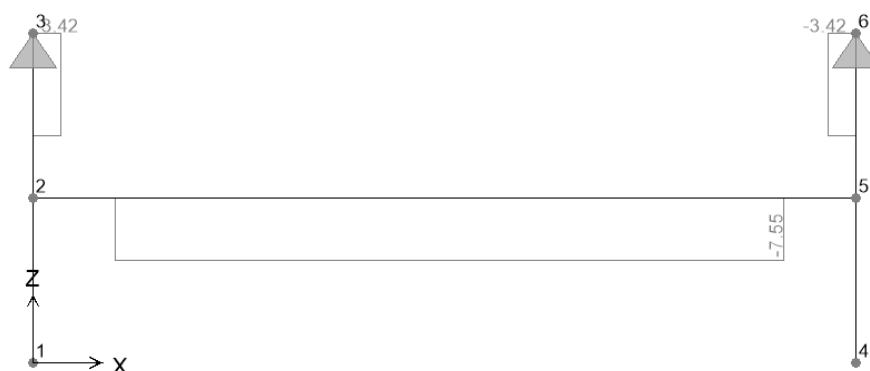
Figura 6.12. Trasverso di campata – Sforzo normale SLU
