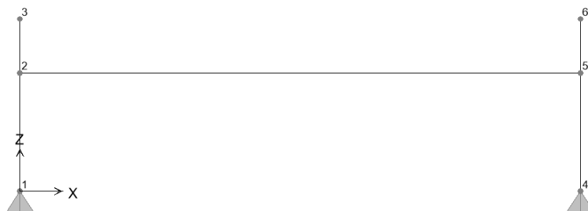
Figura 6.14. Modello di calcolo - Trasverso di appoggio – spalla
