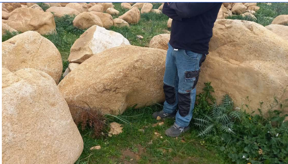
Fig.5 Massi di granito tondeggianti (max 3 ton) provenienti da lavori di scavo e spietramento
