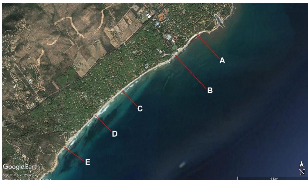
Figura 2-1 Posizione dei cinque profili trasversali individuati nello Studio meteoamarino [1] come rappresentativi per il calcolo del trasporto sedimentario longshore di lungo periodo (base: immagine Google Earth Pro)
