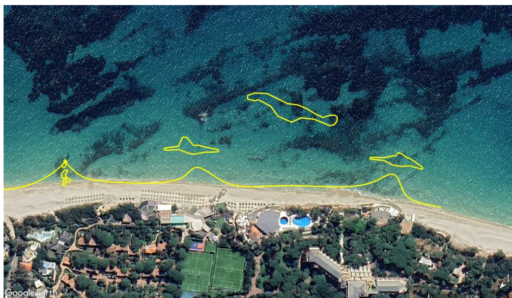
Figura 2-5 Configurazione iniziale della linea di riva con due salienti a tergo delle due isole più sottocosta e aggiramento del pennello semitrasparente con il ripascimento. Il volume di ripascimento iniziale corrisponde a circa 19'000 m 3
