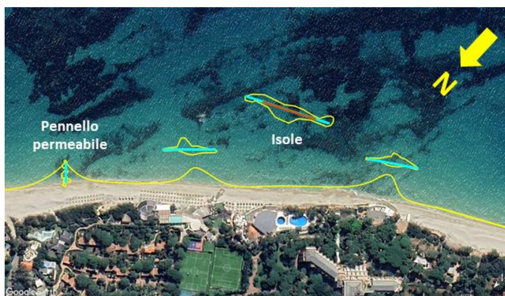
Figura 2-6 Strutture considerate nel modello di evoluzione della linea di riva
