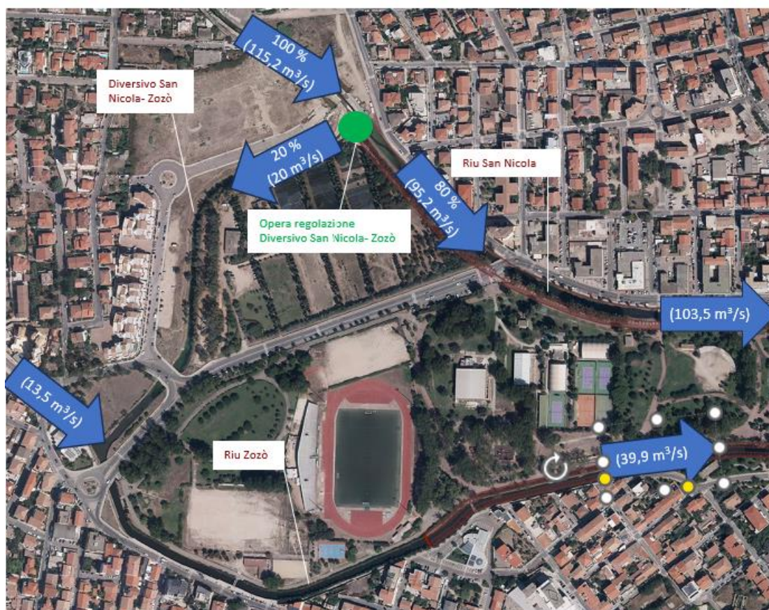
Figura 2.3 - Ripartizione delle portate nel nodo del Diversivo San Nicola – Zozò nello stato di progetto. (SDP) (portate del modello idrologico).
