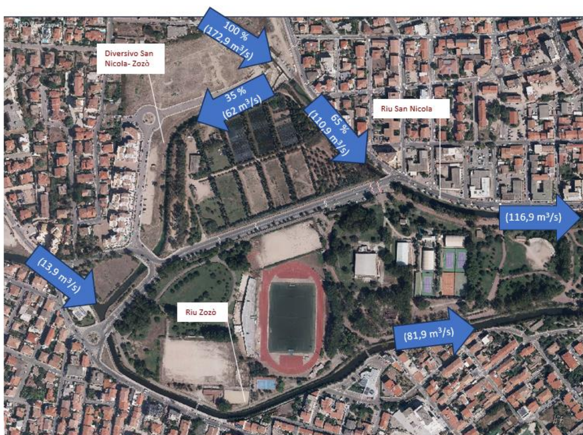
Figura 2.2 - Ripartizione delle portate nel nodo del Diversivo San Nicola – Zozò nello stato di fatto (SDF) (portate del modello idrologico).
