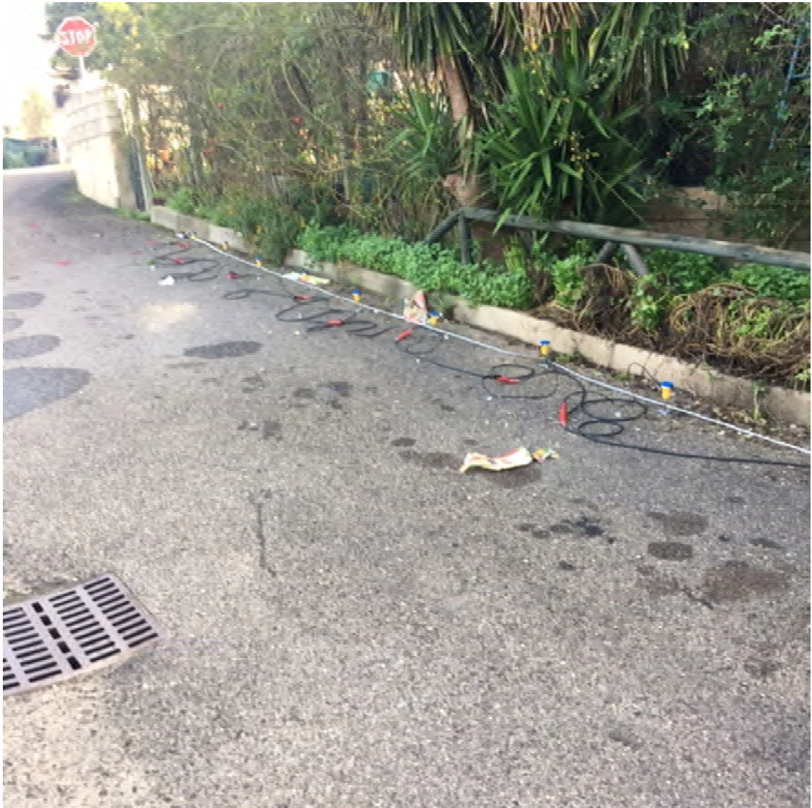
Foto n. 7 L'allineamento dei geofoni visto dal centro dello stendimento.
