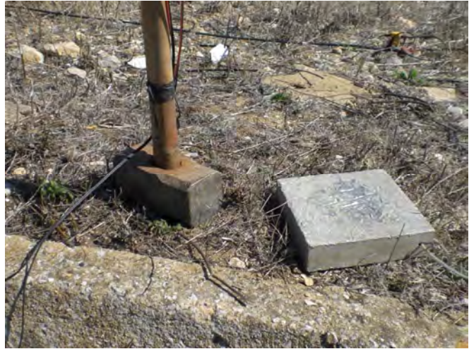
Foto n. 3 La mazza strumentata e il piattello di battuta.
